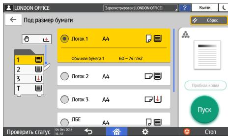
Если ориентация оригинала и бумаги в лотке не совпадают, производится автоматический поворот копируемого изображения. Например, чтобы уменьшить оригинал формата A3 (11 × 17) до A4 (8 1/2 × 11), можно выбрать формат A4 (8 1/2 × 11)□ или A4 (8 1/2 × 11)□.
