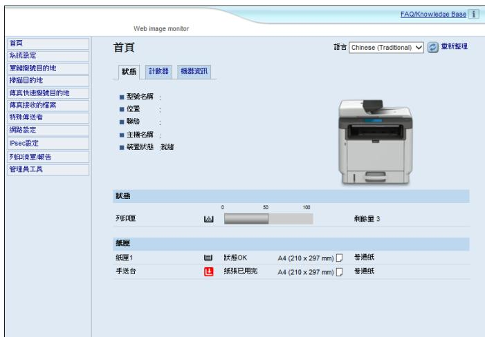
您可使用 Web Image Monitor 直接存取本機，以檢查機器的狀態或進行設定。
