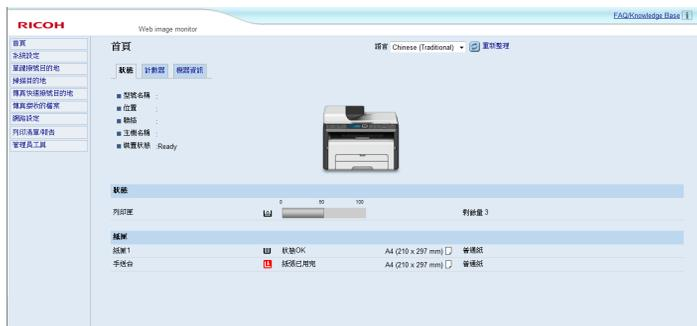
您可使用 Web Image Monitor 直接存取本機，以檢查機器的狀態或進行設定。
