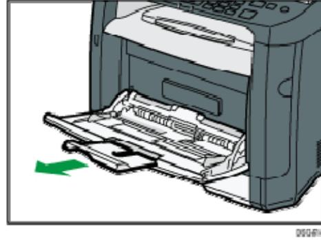
2. حرك الموجهات الجانبية للخارج، ثم قم بتحميل الأظرف بحيث يكون جانب الطباعة متجهًا لأعلى، ثم ادفعها مقابل الجهاز حتى تتوقف.
