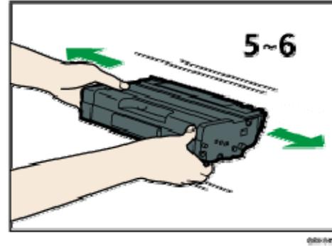
7. يتحسن حتى توزيع مسحوق الحبر داخل الزجاجية. حرك خرطوشة الطباعة في اتجاه أفقي. وإذا ثبتت الخرطوشة دون تحرك، فارفعها قليلاً وادفعها حتى تدخل بالكامل. ثم اضغط على الخرطوشة لأسفل حتى تستقر في مكانها.
