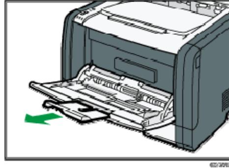
2. حرك الموجهات الجانبية للخارج، ثم قم بتحميل الورق بحيث يكون جانب الطباعة متجهًا لأعلى، ثم ادفعه مقابل الجهاز حتى يتوقف.
