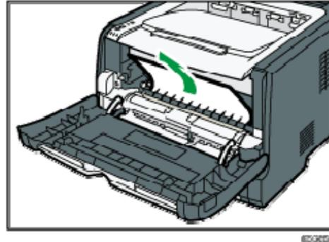
14. حرك خرطوشة الطباعة في اتجاه أفقي. وإذا ثبتت الخرطوشة دون تحرك، فارفعها قليلاً وادفعها حتى تدخل بالكامل. ثم اضغط على الخرطوشة لأسفل حتى تستقر في مكانها.
