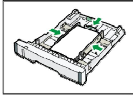
5. عند تحميل ورق بحجم مخصص، اضبط موجه الورق على أن يكوناً أوسع قليلاً من حجم الورق الفعلي. تحقق من عدم وجود أية فجوات بين الورق وموجهات الورق؛ سواء الجانبية أم الطرفية.
