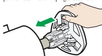
6 Insérez lentement la bobine dans le palier gauche de façon à ne pas endommager le palier, puis abaissez le levier de verrouillage sur le palier gauche.
