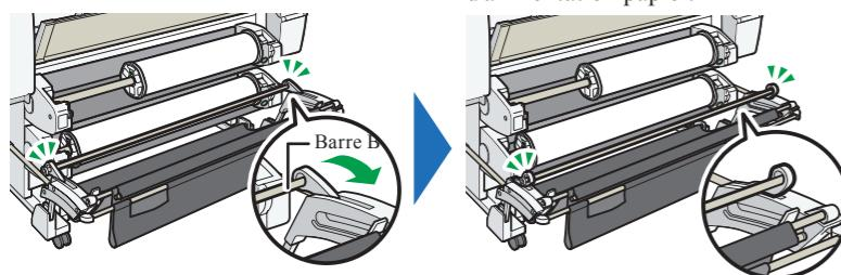
6 Appuyez sur le bouton de rembobinage à droite de l'emplacement d'entrée du papier pendant une seconde ou plus.
