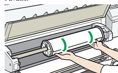
3 Faites tourner le rouleau papier de façon à ce que le bord du papier se trouve au-dessus des guides inférieurs.
