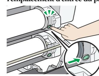
En relâchant le bouton, le papier se rembobine automatiquement. Si le papier n'est pas rembobiné, appuyez à nouveau sur le bouton. S'il n'y a pas de rouleau de papier, passez à l'étape 4 d'« Insertion du spouleur dans le rouleau papier ».
