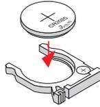
取出舊電池並安裝新電池 (CR2025)。確定有「+」標記的那面朝上。
