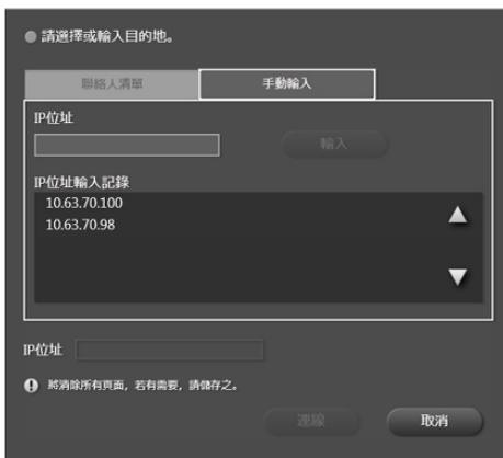
以手動輸入方式，指定主持白板的 IP 位址。使用觸控鍵盤輸入位址後，請觸碰[輸入]。隨即顯示關於記錄的確認訊息。如果不要在記錄中保留已輸入的 IP 位址，請觸碰[取消]來回應此訊息。
