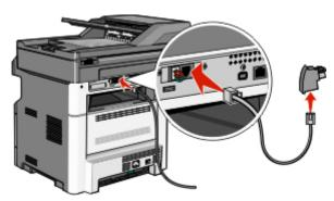
3 Conecte o adaptador no slot N de uma tomada de telefone analógico ativa.
