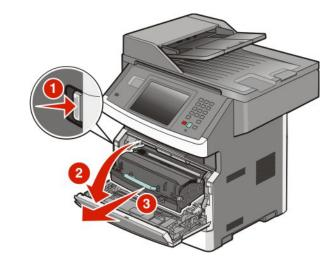
**2** Levante a aba da parte frontal da impressora e remova os atolamentos.
