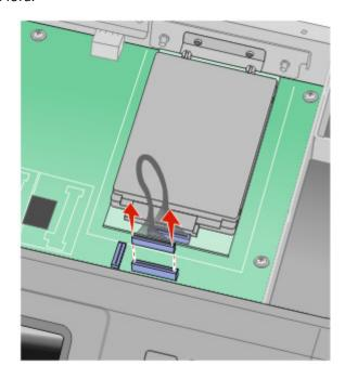
**b** Remova os parafusos que estão fixando o disco rígido da impressora.
