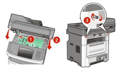
**Aviso—Dano Potencial:** Certifique-se de que a placa do sistema esteja travada para impedir danos possíveis à impressora se ela for movimentada.
