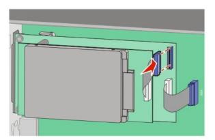
Para instalar o disco rígido da impressora diretamente na placa do sistema:
