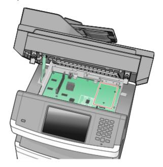
**Nota:** Caso uma ISP opcional já esteja instalada, o disco rígido da impressora deve ser instalado sobre a ISP. Instalação de um disco rígido da impressora na ISP:
