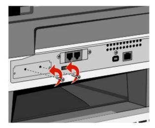
**c** Remova o disco rígido da impressora puxando-o para cima para desinstalar os afastadores.
