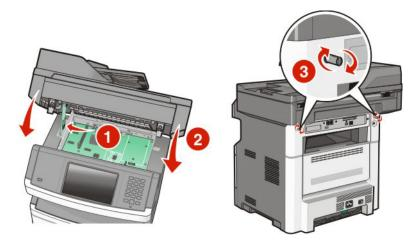
**Aviso—Dano Potencial:** Certifique-se de que a placa do sistema esteja travada para impedir danos possíveis à impressora se ela for movimentada.
