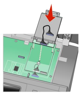
c Insira o plug do cabo da interface do disco rígido da impressora no receptor da ISP.
