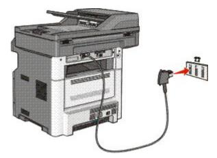
**4** Se desejar usar a mesma linha para a comunicação por fax e telefone, conecte uma segunda linha de telefone (não fornecida) entre o telefone e o slot F de uma tomada de telefone analógica ativa.
