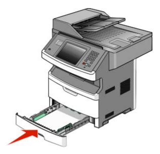
**7** Se um outro tipo de papel tiver sido carregado, diferente daquele carregado anteriormente na bandeja, altere a configuração Tipo de Papel.
