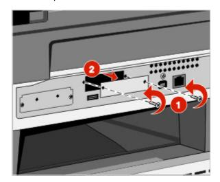
4 Insira a placa de fax e depois aperte os dois parafusos para prender a braçaderira de montagem da placa.
