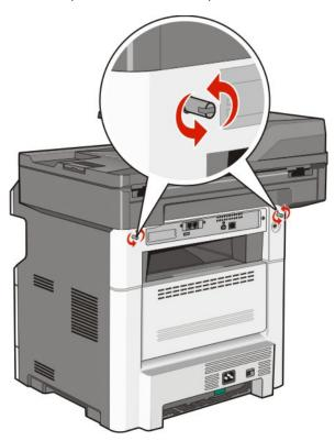
2 Erga a parte da frente da unidade do scanner para abrir a placa do sistema.
