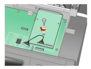
**9** Conecte os dois parafusos fornecidos para fixar o suporte de montagem da ISP na gaiola da placa do sistema.
