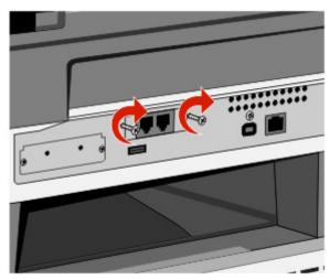
5 Insira o plug da interface do cabo da placa de fax no receptor da placa do sistema.
