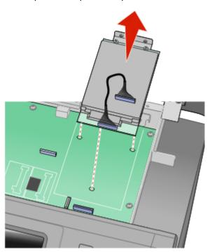
**d** Remova os parafusos de aperto manual que prendem o suporte de montagem do disco rígido da impressora ao disco rígido da impressora e, em seguida, remova o console. Deixe o disco rígido da impressora de lado.
