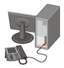
6 Conecte um cabo adicional de telefone da porta do modem do computador até a 🗓 porta EXT da impressora 🗐.
