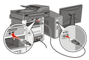
**Nota:** Após configurar a impressora, o software passará as informações para desconectar temporariamente o cabo USB para que você possa imprimir com uma conexão wireless.
