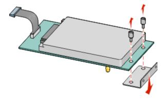
**b** Alinhe os afastadores do disco rígido da impressora aos buracos na ISP e, em seguida, pressione para baixo no disco rígido da impressora até que os afastadores estejam fixados no lugar.
