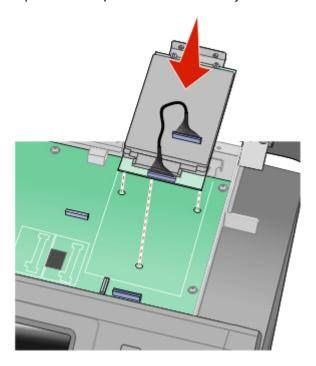
**b** Conecte os dois parafusos fornecidos para fixar o suporte de montagem do disco rígido da impressora.
