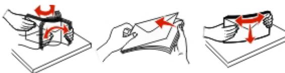
**Remarque :** ventiler les enveloppes permet d'éviter que leurs bords ne se collent les uns aux autres. Cela permet également de les charger correctement évitant ainsi tout bourrage papier. Ne pliez pas les enveloppes et ne les froissez pas.
