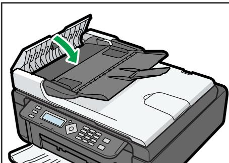
4. 提起 ADF，如果 ADF 中残留有原稿，请轻拉卡住的原稿以取出它。
