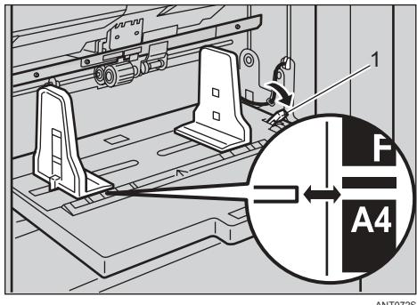
1: Зажимной рычаг боковой стойки узла подачи бумаги
