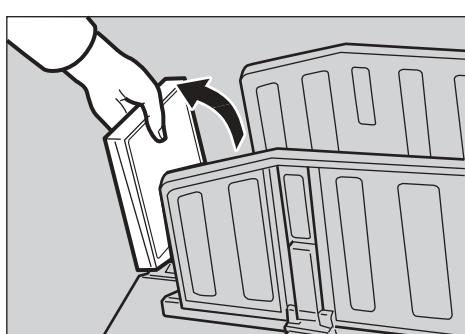
**4** Поднимите концевую планку приемного лотка и отрегулируйте ее так, чтобы она соответствовала формату бумаги.
