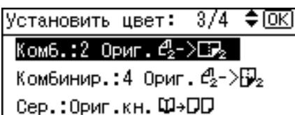
**3 С помощью клавиши [ $\blacktriangle$ ] или [ $\blacktriangledown$ ] выберите ориентацию оригинала, а затем нажмите клавишу [OK].**
