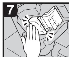
7. Нажмите на картридж до щелчка и поднимите рычаг.
