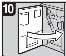
11. Втолкните блок сшивания обратно, а затем закройте переднюю крышку финишера.
