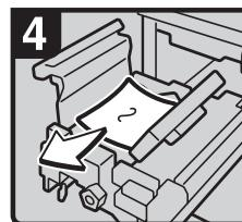
5. Удалите замятую бумагу и верните рычаг D3 и рычаг D4 в первоначальное положение.
