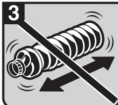
4. Картридж с тонером нельзя сильно встряхивать, в противном случае тонер может пролиться.
