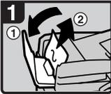
1. 打开自动送稿器 (ADF) 的盖板, 取出卡住的原稿。
