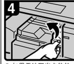
5. 如果无法取出卡住的纸张，请打开桥接单元右盖。
