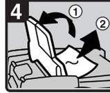
4. 如果无法取出卡住的原稿, 请打开ADF的外盖, 取出卡住的原稿。
